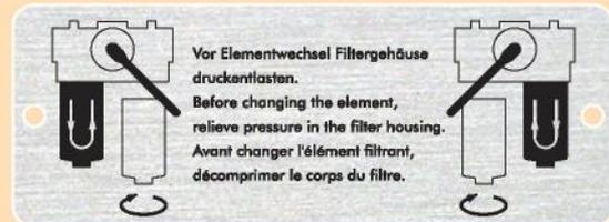
Vor Elementwechsel Filtergehäuse druckentlasten.
